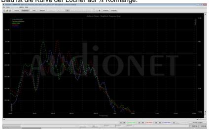
Zur besseren Erkennbarkeit hier in einer weiter geglätteten Ansicht (Auflösung ½ Oktve). Die grüne Kurve, also auf halber Rohrlänge, zeigt keinen schlechten Charakter, allerdings verschiebt sich die Resofrequenz stark nach oben und liegt jetzt bei 70 Hz. Unsere ursprüngliche Resofrequenz bei 41 Hz ist um 10 dB leiser geworden.
