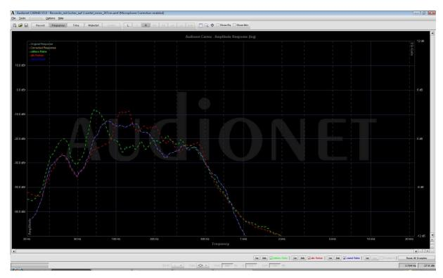
Zur Verdeutlichung hier noch einmal übereinandergelegt das Rohr mit ganz leichter Dämmung (gelb) und das Rohr ohne Dämmung mit Loch auf ½ Rohrlänge, rot (Auflösung ½ Oktve).
