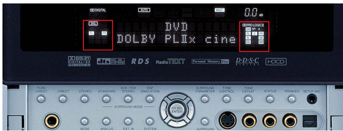
Hier bleibt keine Frage offen: Zweizeiliges Display mit zusätzlicher Icon-Anzeige für Kanalanzahl der Ein- und Ausgangskonfiguration
