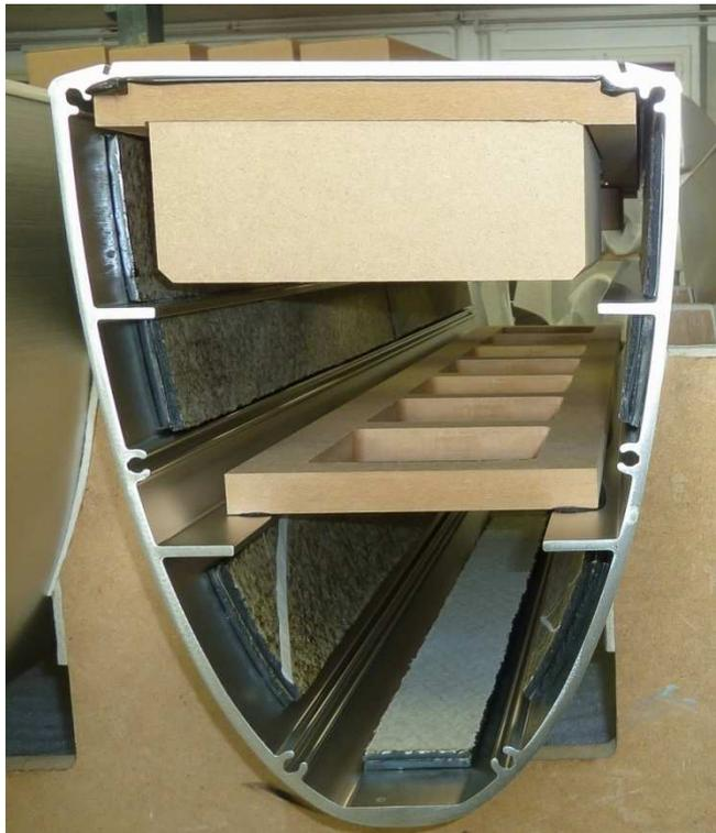
Das Gehäuse im Rohbau. Hier sieht man sehr schön das Profil mit den zusätzlichen Versteifungsstreben ab Baujahr 2011.
