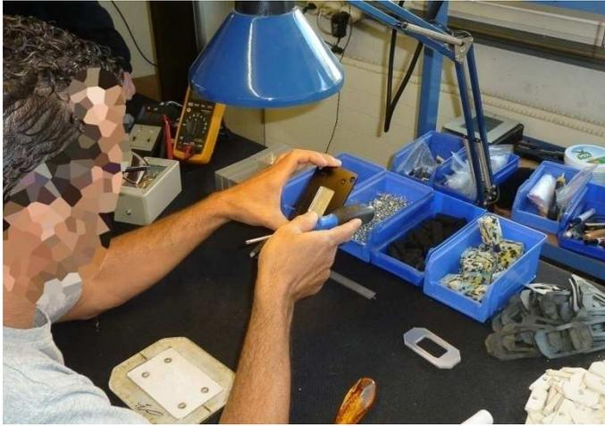
Kleine Schläge mit dem Gummigriff erhöhen hier nicht das Denkvermögen, sondern sorgen für die perfekte Zentrierung der Membran. Von der Funktion her spielt eine leicht schief sitzende Membran keine Rolle, aber das würde den Perfektionsdrang des Erbauers stören.
