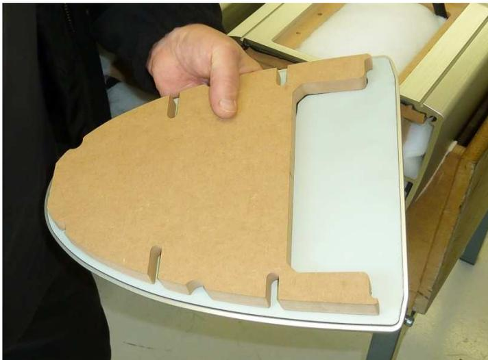
Die Gehäuse sind nach dem Bau akustisch nahezu tot; um auch Deckel und Bodenplatte zu "töten", erfolgt auch hier ein Schichtaufbau bestehend aus der Alu-, einer Dämm- und einer MDF-Platte. Nachdem der Kleber abgetrocknet ist, werden Deckel und Boden mit dem Gehäuse verschraubt.
