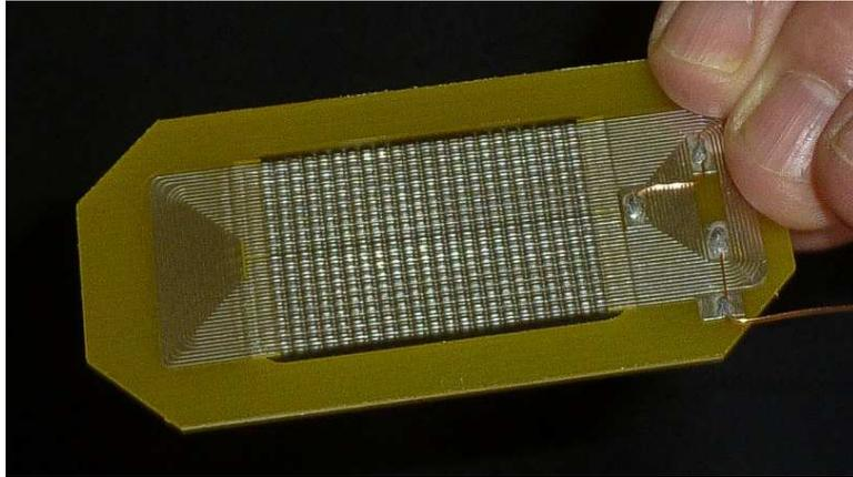
Die hochempfindliche Hochtonfolie des LDR MK II. Gut zu erkennen die gelbliche Trägerfolie und die Leiterbahn aus Aluminium mit Anschlussfäden. Die kleinen "Rechtecke" werden geprägt, sie dienen der Steifigkeit der Membran und zur Verbesserung des Resonanzverhaltens. Diese "unscheinbare" Prägung
