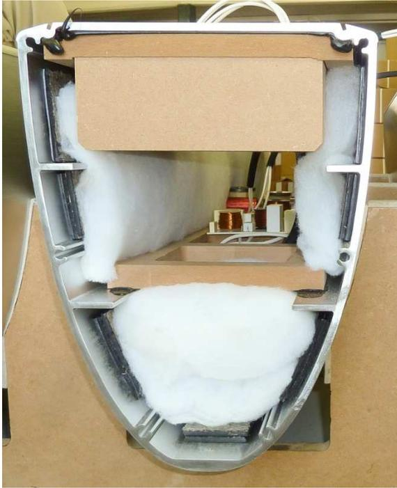
Der nächste Schritt ist die Polsterwolle zur Reduzierung stehender Wellen und die Weiche mit den Anschlusskabeln.
